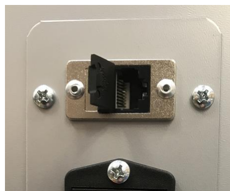
Collegamento pannello di comando S all'unità
