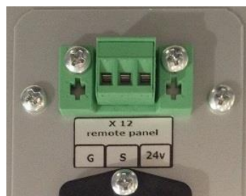
Collegamento pannello di comando F all'unità
