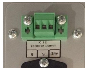
Collegamento pannello di comando E all'unità
