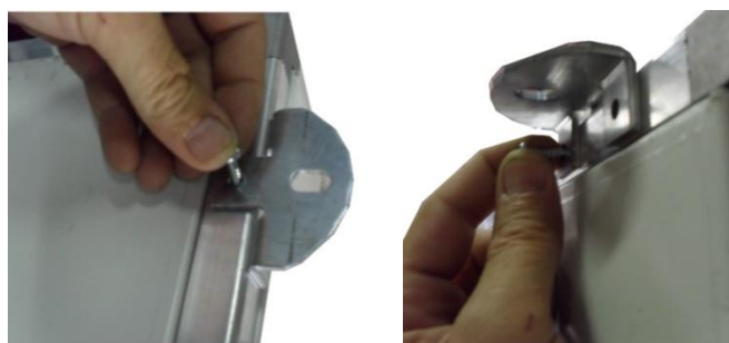
Figura 1 - Fissaggio delle staffe fornite a corredo
