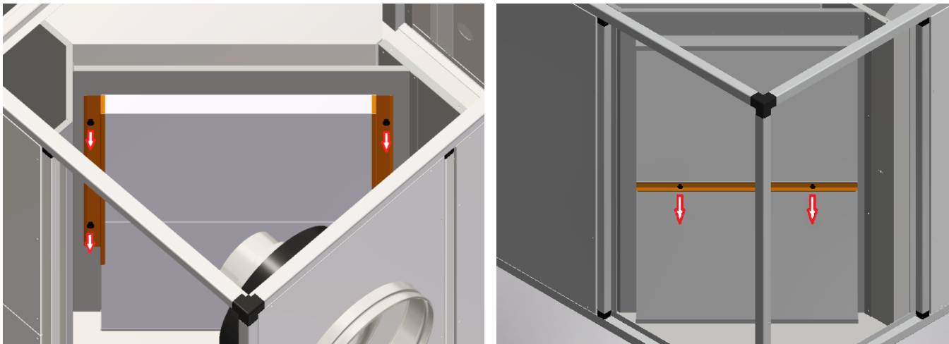
Figura 7 – Sequenza operazioni per rimuovere i filtri nelle unità di taglia grande: togliere i fermi filtro (dopo aver svitato le relative viti/pomelli di fissaggio) ed estrarre i filtri dal coperchio frontale o dai pannelli laterali.
